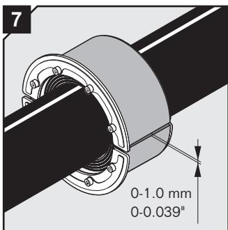
Обеспечить зазор между двумя половинами муфты в пределах от 0 мм до 1,0 мм, зажав между ними кабель или трубу.
