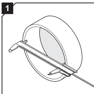
Просверлить отверстие или измерить диаметр существующего отверстия.
