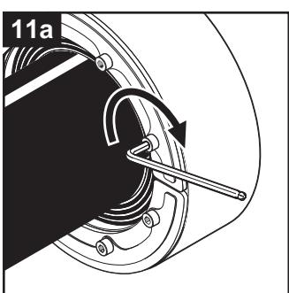
Постепенно в несколько приемов затягивать болты в перекрестном порядке до полной затяжки.
