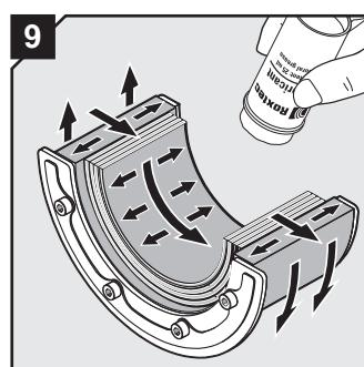
Нанести смазку Roxtec Lubricant на внутренние и внешние поверхности уплотнения.
