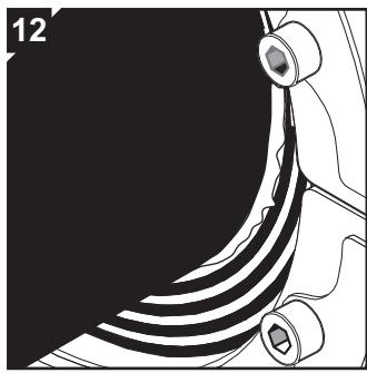
После затяжки должны быть видны излишки смазки, выдавленные наружу.
