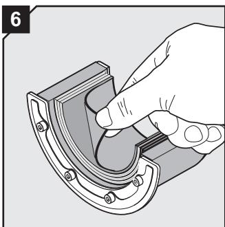
Подогнать муфту RS посредством удаления слоев резины с каждой половинки, до получения зазора, показанного на этапе 7. Количество слоев на половинках муфты не должно отличаться более чем на один слой.
